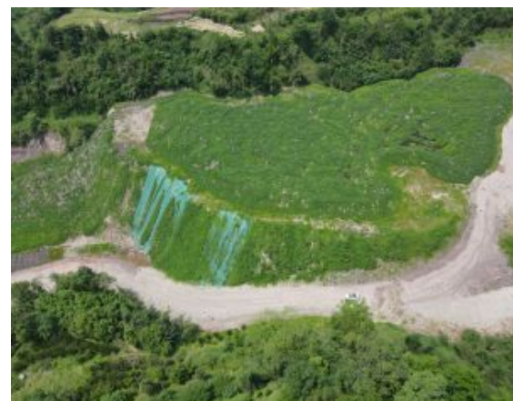
斑竹村弃渣场挡护、表土剥离、排水沟、临时绿化等水保措施
