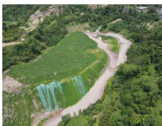
斑竹村弃渣场挡护、表土剥离、排水沟、临时绿化等水保措施
